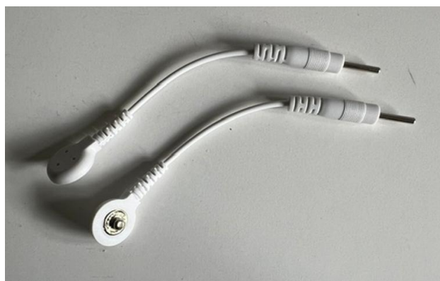
Figur 1. Exempel på adapter mellan tryckknappskontakt och 2-mm-stift. Bilden visar kontaktyperna, inte verifierad kompatibilitet med en viss stimulator eller elektrod.
